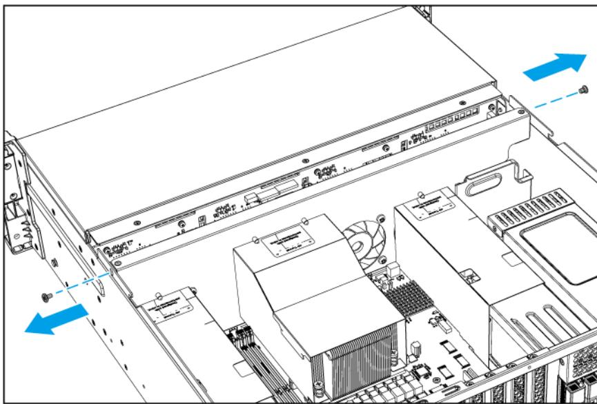
b. CPU ファンダクトの底面フックを CPU ヒートシンクのネジから外します。
