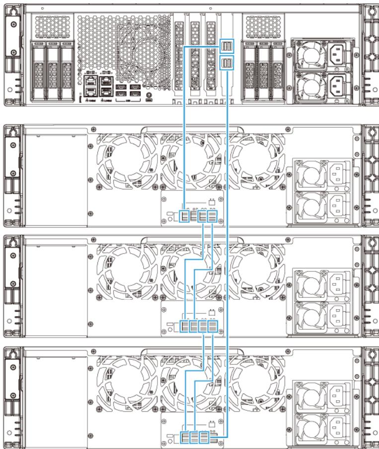
QNAP は、拡張ユニットの不具合やケーブルの切断によるストレージのダウンタイムを防ぐためにデュアルパス構成の使用をお勧めしています。シングルパス構成は、デュアルパス構成が不可能な状況でのみ使用してください。
