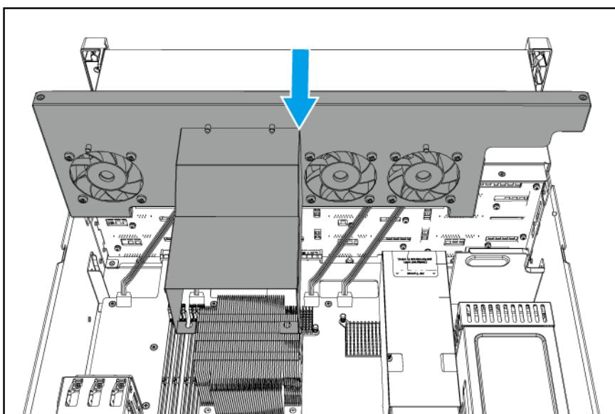
c. CPU ファンダクトの底面フックを CPU ヒートシンクのネジに取り付けてください。
